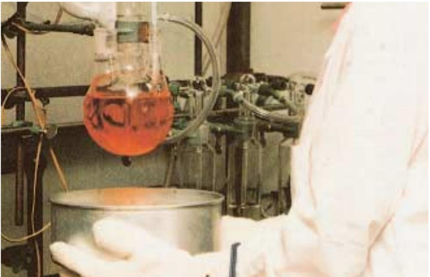
Heizbäder mit Gasbrennern dürfen nur für nicht brennbare Flüssigkeiten und unter ständiger Beobachtung verwendet werden. Vorzuziehen und allgemein geeignet sind stufenlos regelbare elektrische Heizplatten. Für unbeaufsichtigte Apparaturen sind selbstregelnde Systeme mit thermostatischer Kontrolle des Heizbades unerlässlich. Gegen die Folgen eines Ausfalls der Regeleinheit muss mit einem Übertemperaturschutz gesichert werden.
