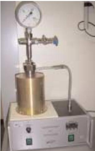
**Glasautoklav mit Drahtkorb** Bild 19b
